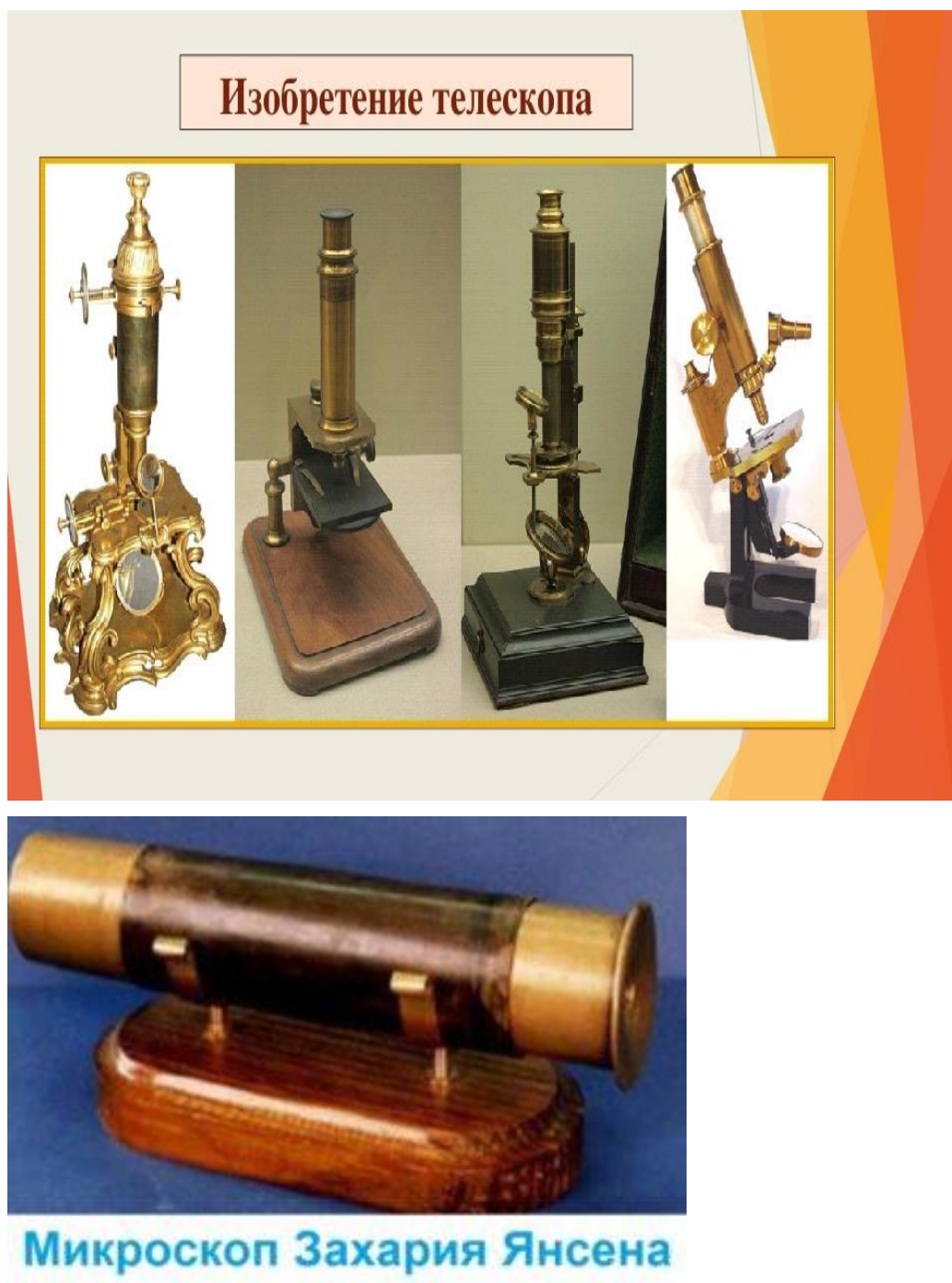
Рис. 1. Световые микроскопы: а – конца XVI в. (изобретатель Захарий Янсен); б – начала XVII в. (изобретатель Галилео Галилей); в – середины XVII в. (изобретатель Роберт Гук)
