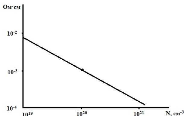
Рис. 1. Зависимость удельного сопротивления от концентрации электронов для кремния, легированного мышьяком
