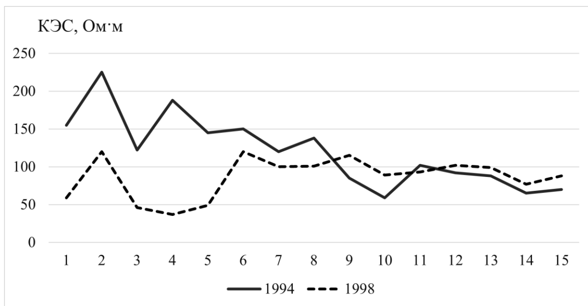
Рис. 1. Результаты электрического профилирования методом сопротивлений (АВ=3 м) через зону аварии нефтепровода
