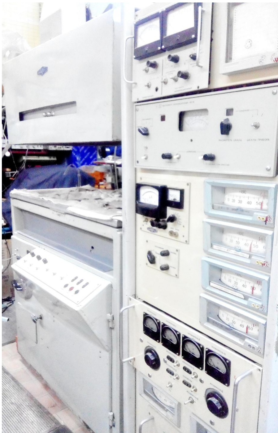
Рис. 22. Сверхвысоковакуумная установка для термовакuumной обработки и заправки измерительных ячеек жидкометаллическими расплавами (лаборатория физики межфазных явлений физического факультета КБГУ)
