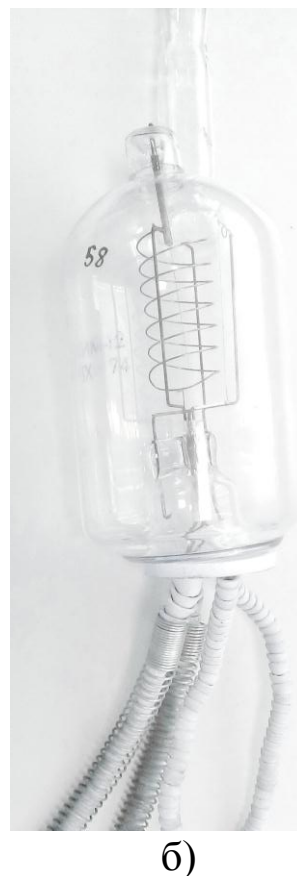
Рис. 9. Конструктивная схема электронного преобразователя: 1 – осевой коллектор, 2 – катод, 3 – сетка, имеющая форму бифилярной спирали с двумя выводами для обезгаживания путем пропускания электрического тока
