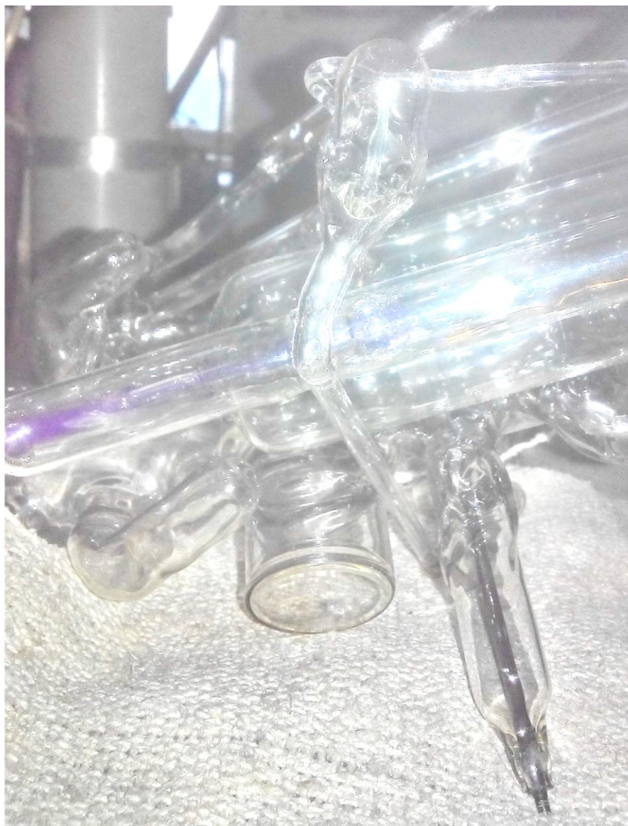
Рис. 55. Место течи (белое светящее пятно) в стеклянной оболочке измерительной ячейки, обнаруженное искровым течеискателем И043.009
