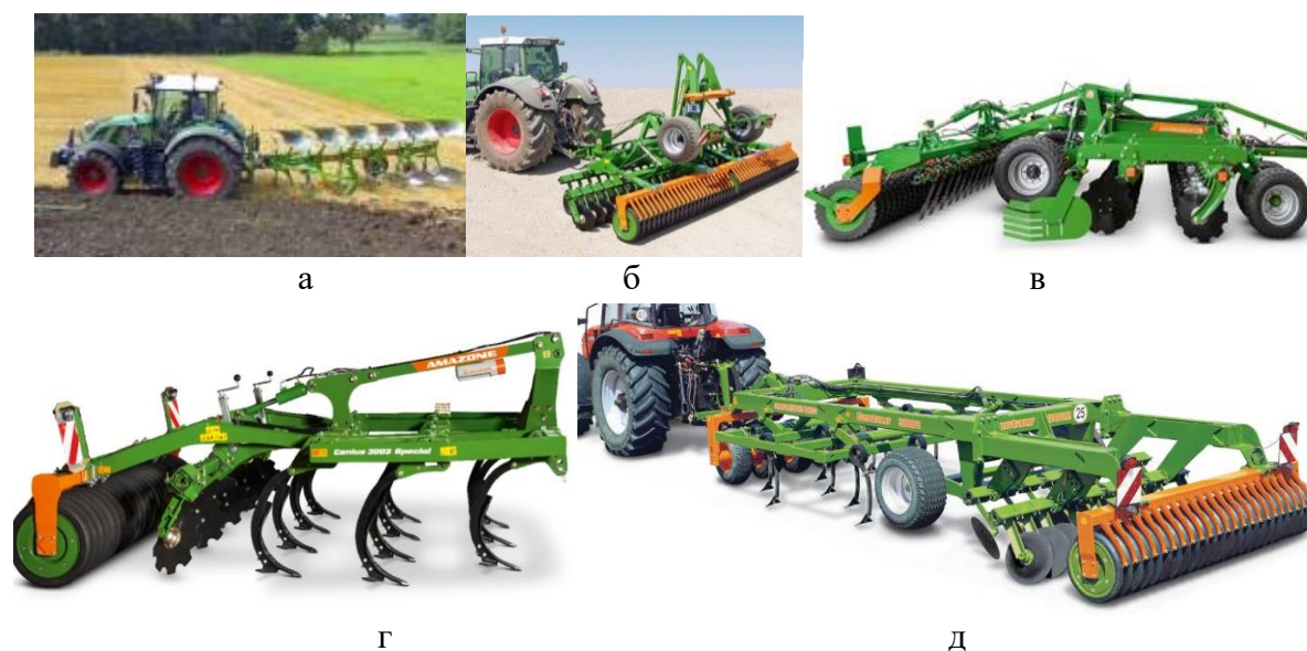
Рис. 1. Почвообрабатывающие орудия компании «AMAZONEN-Werke»: а) навесной оборотный плуг Cayton; б) дисковая борона Catros; в) тяжелая дисковая борона Certos; г) культиватор Senius; д) культиватор Centaur.
